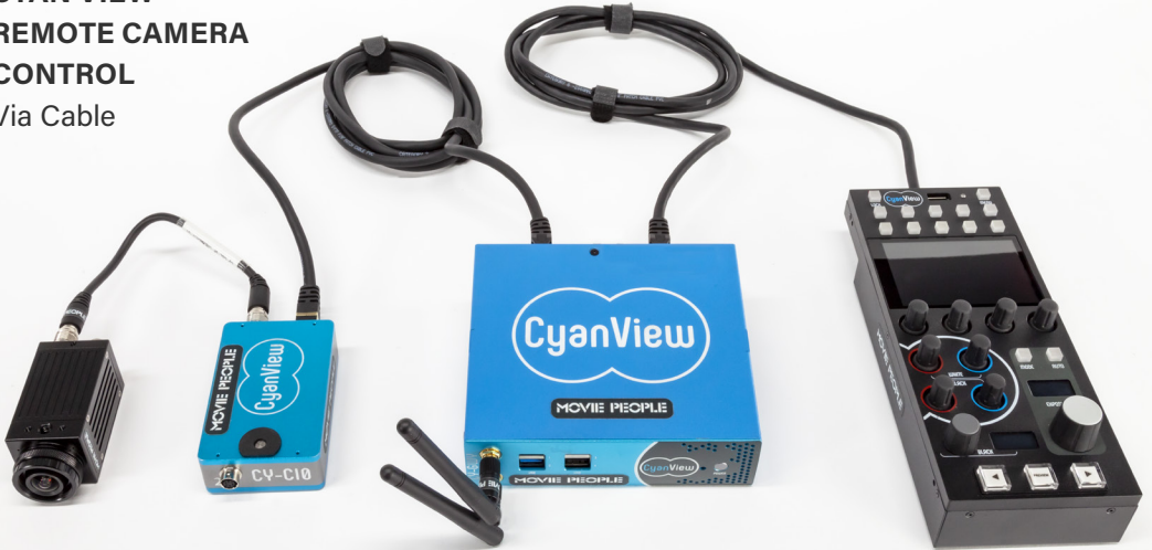
Camere Atom + CyanView C10 → CyanView GWY + CyanView RCP Camera Control Unit
